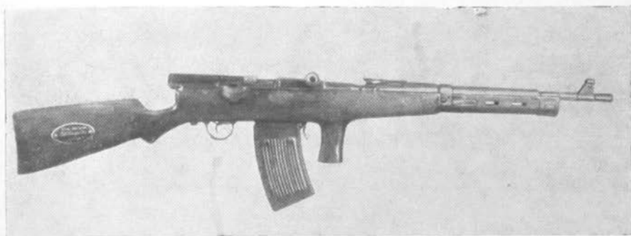
Автомат системы В. Г. Федорова образца 1916 г. Калибр 6,5 мм.
