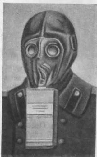
Один из первых образцов противогаза Н. Д. Зелинского
