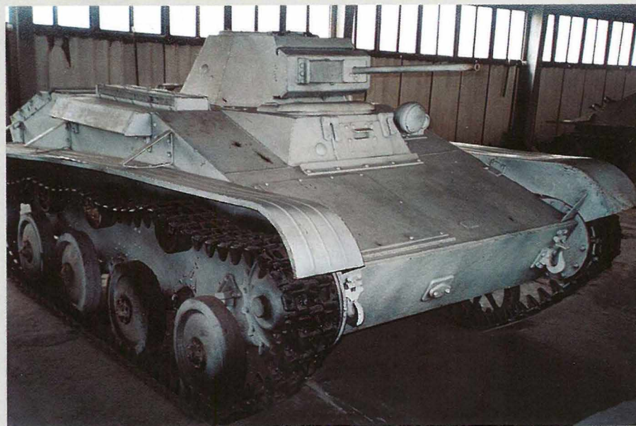
Легкий танк Т-60, основным вооружени- ем которого была ТНШ - одна из модификаций автоматической пушки ШВАК.
